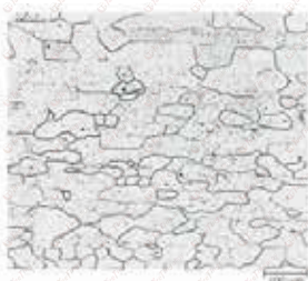
熱延純鉄板(板厚: 3.0mm, No.1 仕上げ)
